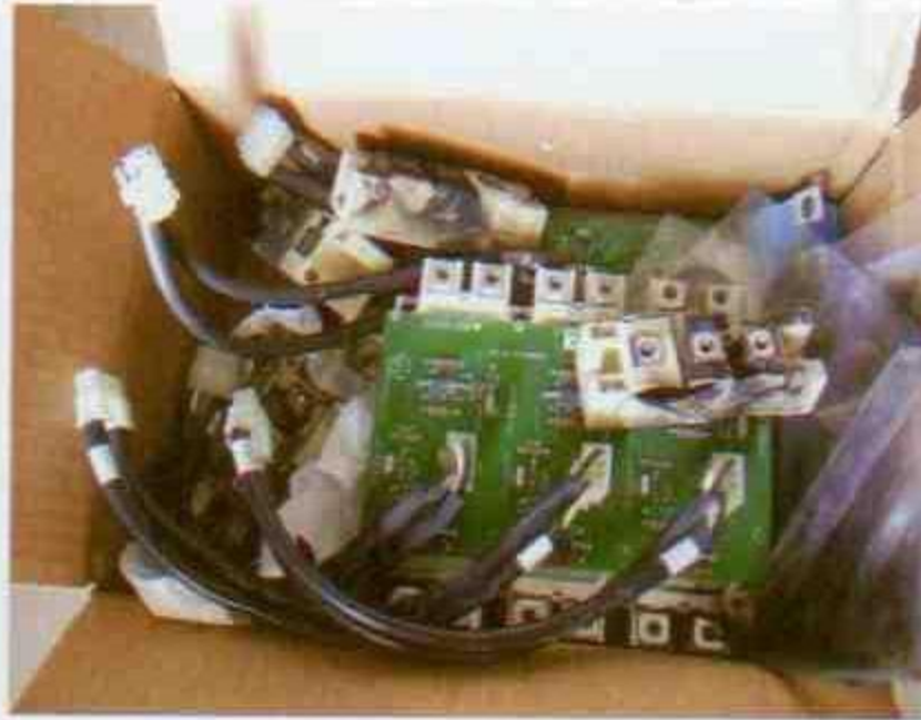
Patlamış Diyot ve IGBT Üniteleri
